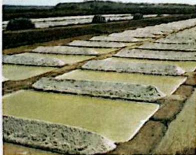
Fig. 18 Salinas para obtenção de sal por evaporação da água do mar
