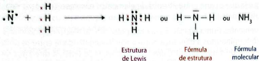
Fig. 8 Modelo molecular da estrutura do amoníaco, NH 3
