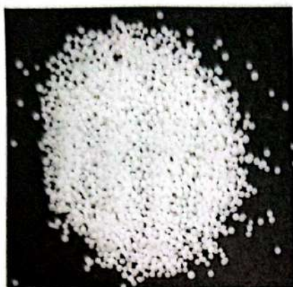
Fig. 4 Nitrato de sódio, \text{NaNO}_3
