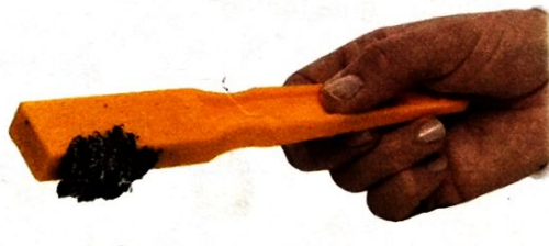
Fig. 33 – Separação magnética de uma mistura de enxofre com limalha de ferro.
