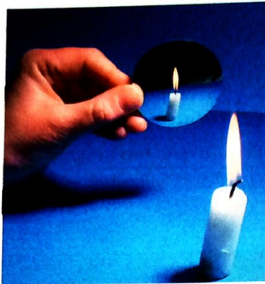
Fig. 6 – A imagem num espelho convexo é sempre menor do que o objecto.
